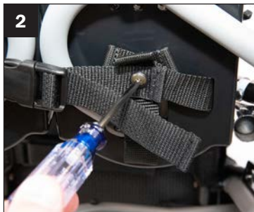
2. Para retirar la correa de sujeción del reposapiés, desenrosque el tornillo de la parte inferior del reposapiés mediante un destornillador.
