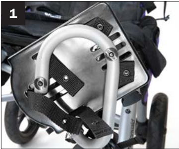
1. Para fijar el colocador para pies, pase la correa por el reposapiés.
