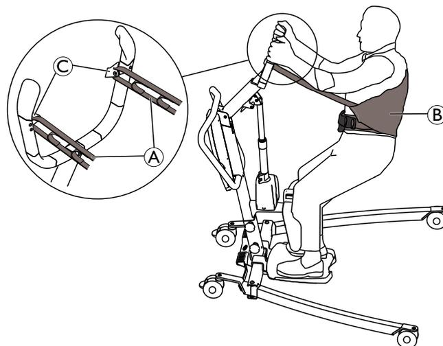
1. Coloque las anillas **A** de la eslinga **B** sobre los ganchos **C** del brazo de elevación.
