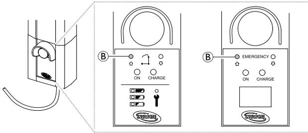
En caso de que falle el mando, el brazo puede levantarse con el botón circular de subida de emergencia. Utilice un objeto afilado, como un lápiz, para presionar el botón.
