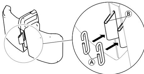
Ensarte los dos ganchos ① en los terminales ② situados en la parte posterior del soporte de pantorrillas.
