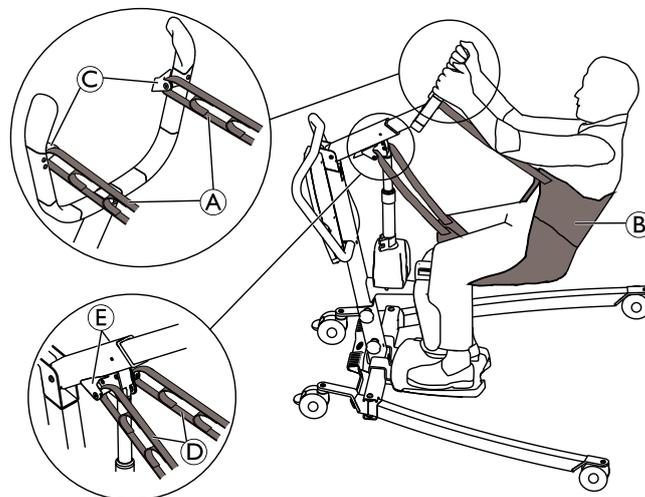
1. Coloque las anillas superiores (A) de la eslinga (B) sobre los ganchos (C) del brazo de elevación.
