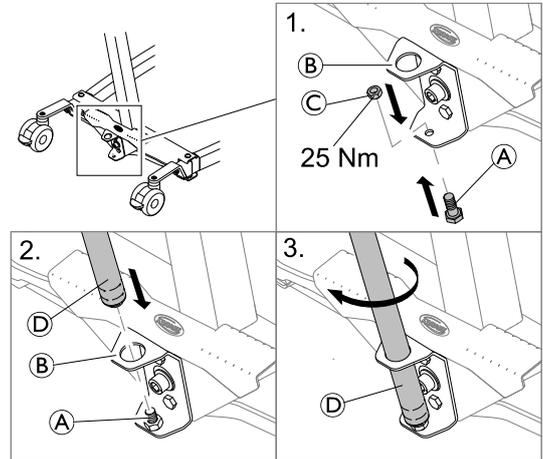
1. Introduzca el tornillo **A** por abajo en el orificio inferior del soporte **B** y fíjelo con la tuerca **C**.
