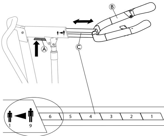
1. Presione y mantenga presionada la palanca roja (A) del brazo.
