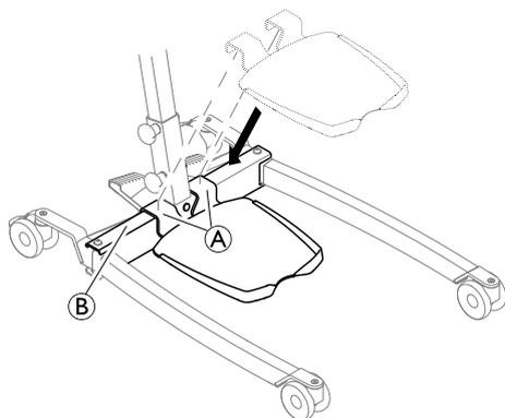
1. Baje la placa de bipedestación sobre la base hasta que los soportes ① encajen completamente en el tubo ②.
