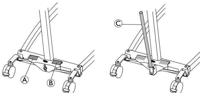
La apertura de patas manual funciona con dos pedales (A y B) o con la palanca (C).
