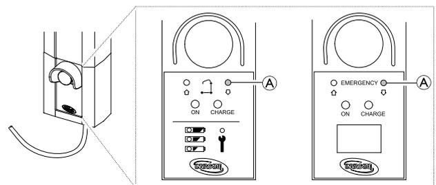
Si falla el mando a distancia, el brazo puede bajar con el botón circular para realizar una liberación de emergencia. Utilice un objeto afilado, como un lápiz, para presionar el botón.
