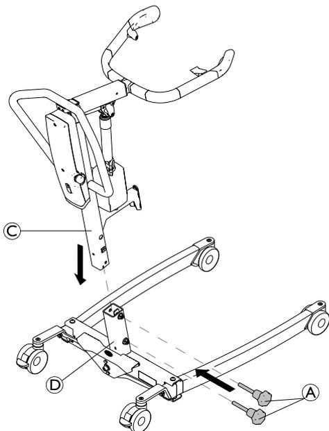
Con el brazo orientado hacia delante, baje el mástil ③ e insértelo en el soporte de la base ④. A continuación, vuelva a colocar las palomillas ① para fijar el mástil ③ a la base.
